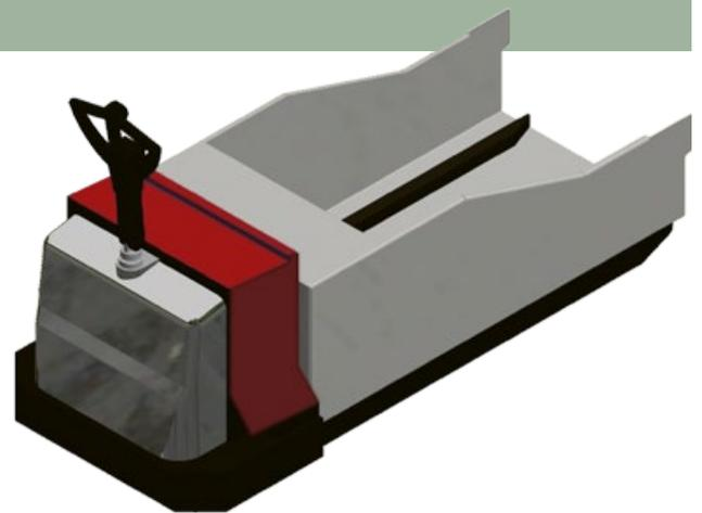
Durch das frei verfahrbare System wird eine hohe Flexibilität erreicht. Ein elektrischer aus- und einfahrbarer Elektromagnet ermöglicht den mühelosen Wechsel zwischen Flurförderzeug und Rollentisch. Eine Verriegelungsvorrichtung gewährleistet stets einen sicheren Transport der Batterie.
